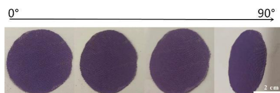
图 8 观察角 0° ~90° 变化时织物结构色的变化
